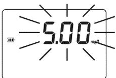
**Acima da gama:** Um valor a intermitente da concentração máxima indica uma condição de acima da gama. A concentração da amostra está acima da gama programada: dilua a amostra e volte a fazer o teste.
