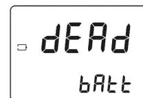
**Dead battery (Pilha morta):** Isto indica que a pilha está morta e deve ser substituída. Uma vez que seja indicada esta mensagem, o medidor bloqueia. Substitua a pilha e reinicie o medidor.
