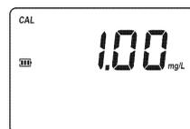
**Nota:** Se o mostrador indicar “STD HIGH”, o valor padrão era demasiado alto. Se o mostrador indicar “STD LOW”, o valor padrão era demasiado baixo. Verifique que ambos as Cuvetes A e B de Padrão CAL CHECK™ HI 96738-11, se encontram livres de impressões digitais e que estão inseridas correctamente.
