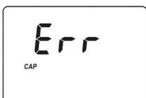
**Erro de tampa:** Aparece quando luz externa entra na célula de análise. Assegure-se que a tampa da cuvete está colocada.
