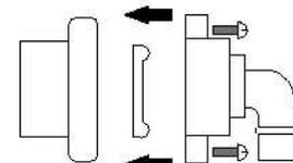
**8.9 - Recoloque o elemento filtrante o sobre a tampa e parafuse a tampa.**
