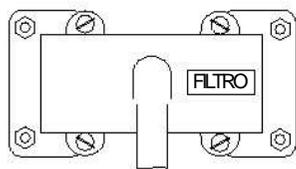
**8.6 - Retire os 04 parafusos de fenda que prendem a tampa do filtro.**
