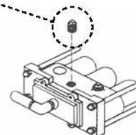
7.3 - Após a lavadora começar a fazer sucção, desligue a máquina e recoloque o bujão.
