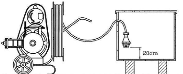
4.2 - Mantenha a extremidade da mangueira ou tubulação de sucção, cerca de 20 cm do fundo da caixa para não aspirar sujeiras (fig. 1).
