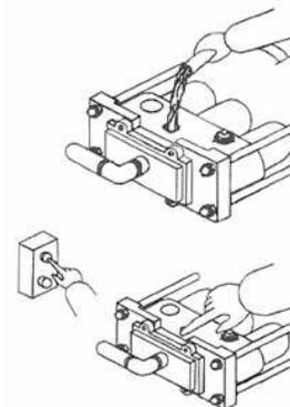
7.2 - Retire o bujão do centro do cabeçote e introduza água até transbordar. Ligue a máquina por 05 segundos e com o dedo indicador verifique se a mesma está tendo sucção no furo do cabeçote. Caso não haja sucção, desligue a máquina e coloque água novamente no furo até transbordar. Repita estes passos até que a lavadora comece a fazer sucção.
