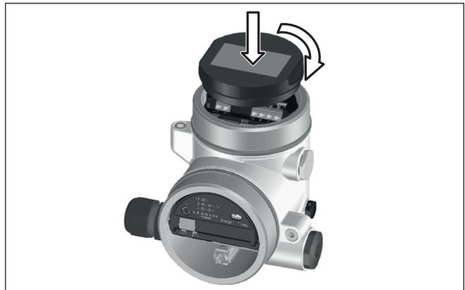
Fig. 5: Colocação do módulo de visualização e configuração
