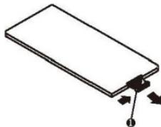
Necessário quando o alcance do controle remoto se torna limitado ou quando não funciona. Substitua por uma bateria CR2025 nova. Certifique-se da polaridade da bateria antes de trocar.
