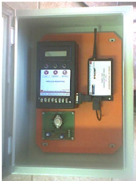
O módulo receptor desenvolvido pela **T&S Equipamentos Eletrônicos**, vem atender de forma prática e versátil as aplicações que necessitam de transmissão de dados por telemetria. Trata-se de um módulo de leitura microcontrolado que se comunica com um modem celular, transmitindo os dados adquiridos para a internet através da plataforma TCP/IP sobre GPRS. Acompanha software de gerenciamento remoto.
