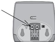
Na parte de trás do Gigaset Repeater existe uma tomada para encaixar o cabo do alimentador. Tendo em conta as medidas indicadas, poderão ser feitos os furos necessários para a montagem do equipamento na parede utilizando os parafusos e buchas fornecidas.
