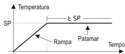
Fig. 2 - Função Rampa ao Patamar
