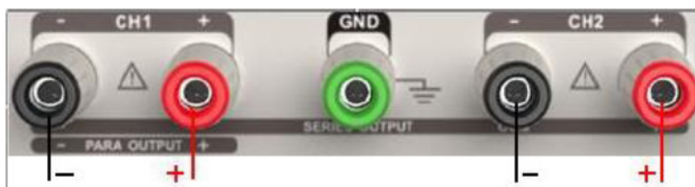
Figura 5 - Operação de Saída Independente CH1/CH2
