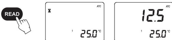
Nota: O último valor de medição será indicado até efectuar a medição da próxima amostra ou até que desligue o instrumento. A temperatura será continuamente actualizada.
