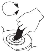
2. Usando pipetas em plástico, deixe cair gotas da amostra sobre a superfície do prisma. Encha o recipiente completamente.
