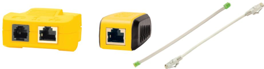
1. **Conecte um ID remoto Test-n-Map™ numerado à porta RJ45/RJ12 de cada sala a ser identificada usando um cabo de ligação em boas condições†. Escreva o número do remoto e o número/descrição da sala em que está colocado para comparar/identificar os cabos mais tarde.**
