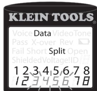
**Cabo T568A com pares divididos:** Um erro comum ao montar um cabo consiste em colocar todos os pares na sequência de pinos 1-2, 3-4, 5-6 e 7-8. Isso resulta em continuidade correta, mas os pares são designados para ficar nos pinos 3-6 e 4-5 no meio do conector para compatibilidade com a fiação de telefone. Esse erro de fiação é detectado somente no teste de par dividido uma vez que os pares designados não são torcidos juntos.
