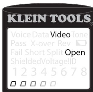
**Cabo coaxial com circuito aberto:** Há uma interrupção na continuidade do cabo. Uma interrupção na blindagem ou no fio central podem causar uma falha de circuito aberto. O cabo não é aprovado e o ID remoto na outra extremidade do cabo não pode ser determinado.
