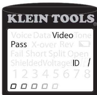
**Cabo coaxial corretamente conectado com ID remoto nº 1:** O ID remoto nº 1 é usado para terminar um cabo coaxial corretamente conectado. O teste de vídeo é aprovado, ID nº 1 é detectado e os "o's" passando na parte inferior da tela indicam que o testador está executando testes continuamente.
