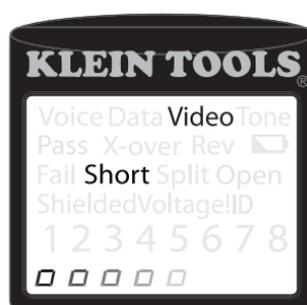
**Cabo coaxial com curto-circuito:** O fio central do cabo está conectado à blindagem, criando um curto-circuito. O cabo não é aprovado e o ID remoto na outra extremidade do cabo não pode ser determinado.
