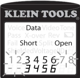
**Cabo T568A com um curto-circuito e um circuito aberto:** O par de pinos 1-2 está em curto e o par 7-8 está aberto. Os pinos com os erros ficam piscando. Linhas tracejadas (-) na linha inferior do display (remoto) indicam o curto, enquanto a ausência de números na linha inferior indica o par aberto.
