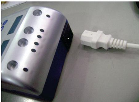
**2º passo:** Conecte o plugue da caneta no equipamento (pode ser conectada somente uma caneta ou as duas), em seguida conecte a ponta na caneta.
