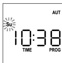
5. Configurar o dia correto através das teclas **UP** e **DOWN** e pressionar a tecla **MENU** para confirmar. Os números das horas ficam intermitentes:
