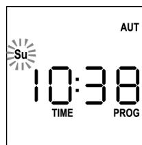
5. Mit Hilfe der **UP**- und **DOWN**-Tasten den korrekten Tag einstellen und zur Bestätigung die **MENÜ**-Taste drücken. Die Ziffern der Stunden beginnen zu blinken:
