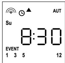
Diese Anzeige weist darauf hin, dass das eingestellte Ereignis einem Öffnungsbefehl ▲ für die Kanäle **1 3 5 12** am Sonntag (**Su**) um **8:30** Uhr entspricht.
