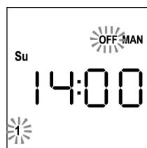
4. Mit den Tasten **UP** und **DOWN** den Zustand des Kanals **ON** (aktiviert) oder **OFF** (deaktiviert) auswählen, zur Bestätigung die **MENÜ**-Taste drücken und zum nächsten Kanal weitergehen.
