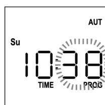
7. Configurar os minutos através das teclas **UP** e **DOWN** e pressionar a tecla **MENU** para confirmar. A palavra **TIME** fica intermitente durante 10 segundos.
