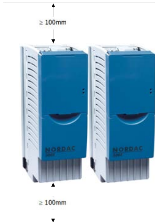
Figura 1: Distâncias de montagem SK 5xxE
