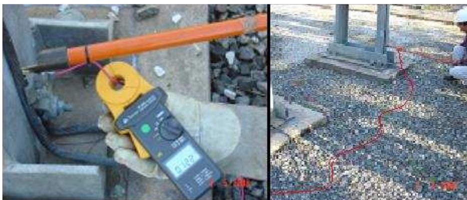
FIGURA 6. MEDIÇÃO NAS DESCIDAS DE DOIS CABOS DE ATERRAMENTO (2 técnicos)
