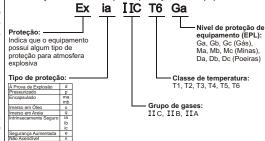
indica que o equipamento possui algum tipo de proteção para ser instalado em áreas classificadas.
