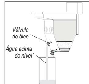
Quando fritar alimentos que produzam resíduos em excesso (farinha de empanados), deve-se proceder com regularidade a sangria do óleo - retirada do excesso de água. Para este procedimento, abra um pouco a válvula do óleo e deixe escorrer o excesso de água da cuba. Quando o óleo começar a sair feche a válvula e volte a operar normalmente.
