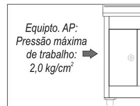
Como o equipamento já sai de fábrica acompanhado de um regulador de pressão ajustado em 1,8kg/cm<sup>2</sup>, sempre verifique, antes de instalar sua fritadeira, se a pressão da rede de gás onde a mesma será instalada é, superior à 2,0kg/cm<sup>2</sup>.
