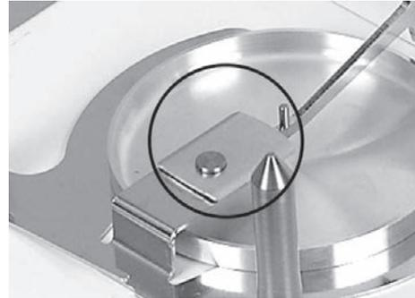
5 Coloque o recipiente de pipetagem no gancho.
