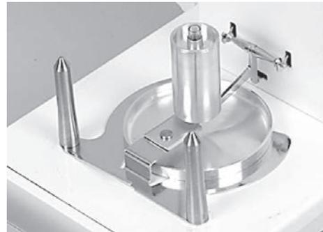
6 Coloque a capela de proteção na coluna da balança e pressione-a firmemente para baixo até o pino de posicionamento.
