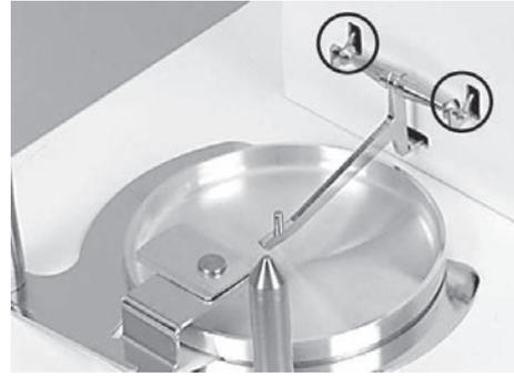
4 Gire a placa de fixação a 90° à esquerda ou à direita até a posição fechada.
