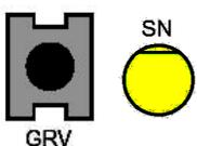
Pressionar e liberar o botão **GRV**, e após gravar na memória o led **SN** irá piscar. Após pressionar o botão **GRV**, a central atualizará a configuração de aplicação conforme os jumpers **CFG2** e **CFG1** (ver item **SELECIONANDO TIPO DE APLICAÇÃO DO PORTÃO**).
