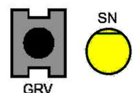
Pressionar e liberar o botão **GRV**, e após gravar na memória o led **SN** irá piscar. Após pressionar o botão **GRV**, a central atualizará a configuração de aplicação conforme os jumpers **CFG2** e **CFG1** (ver item **SELECIONANDO TIPO DE APLICAÇÃO DO PORTÃO**).
