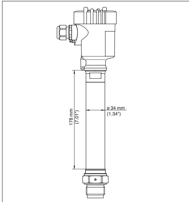
Fig. 53: Adaptador de temperatura
