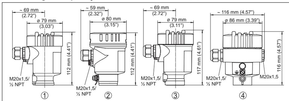
Fig. 50: Modelos da caixa com grau de proteção IP 66/IP 67 e IP 66/IP 68; 0,2 bar
