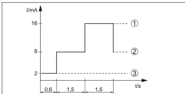
Fig. 36: Diagrama do teste de funcionamento
