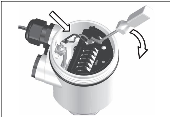
Fig. 8: Passos 5 e 6 do procedimento de conexão
