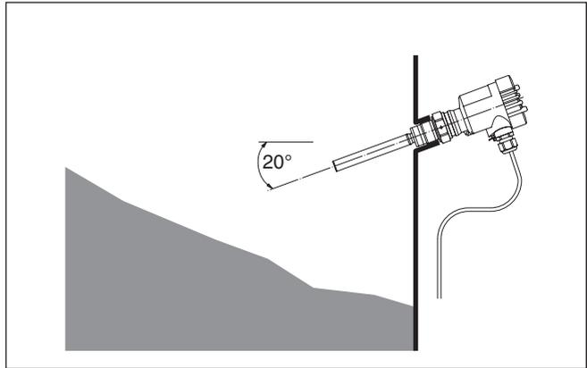
Fig. 4: Montagem horizontal
