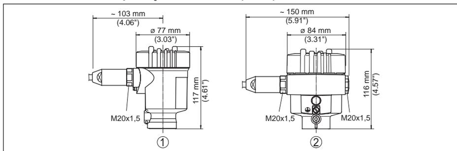
Fig. 51: Modelos da caixa com proteção IP 66/IP 68 (1 bar)
