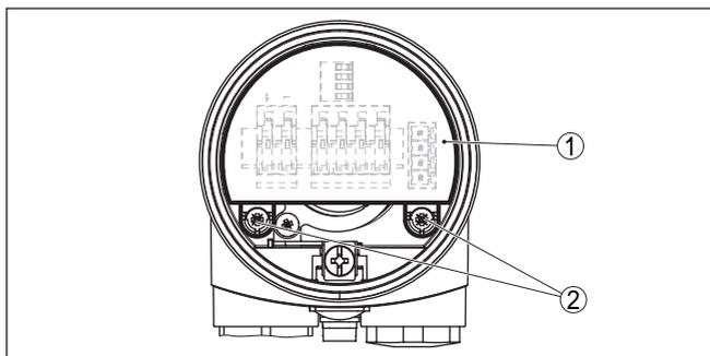
Fig. 47: Soltar os parafusos de fixação
