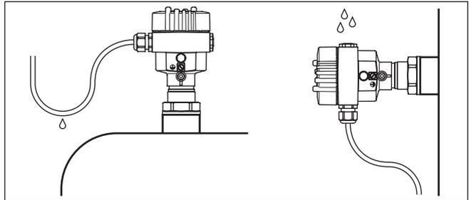
Fig. 2: Medidas para evitar a entrada de umidade
