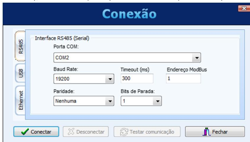
Após efetuar a conexão, a próxima tela irá mostrar algumas informações do aparelho (muito útil para certificar-se de que está acessando o equipamento correto, principalmente quando se está coletando os dados via Ethernet/Modbus TCP ou RS485/Modbus RTU e há vários **FieldLoggers** na rede). Deve-se então escolher a memória do **FieldLogger** onde os dados de registro estão (flash interna ou cartão SD).
