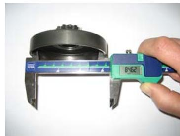
**7.14.4.5. Altura da campânula com o pinhão montado.** A altura mínima é de **33,90mm**.
