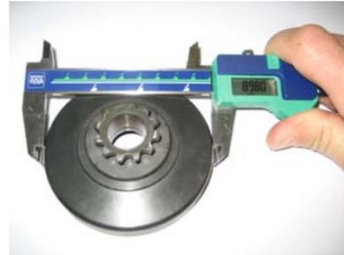
**6.13.8.3. Diâmetro interior da campânula.** A medição deve ser feita no meio (na área de contacto da campânula). O valor máximo do diâmetro interior é de **84,90 mm**.
