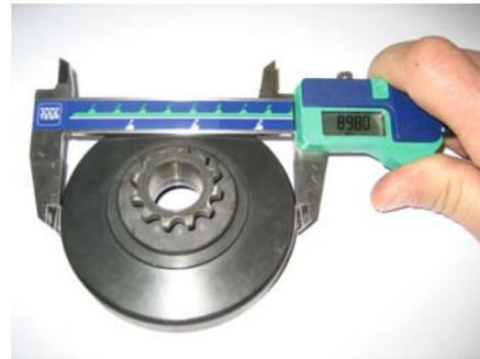
**7.14.4.4. Diâmetro interior da campânula.** A medição deve ser feita no meio (na área de contacto da campânula). O valor máximo do diâmetro interior é de **84,90 mm**.
