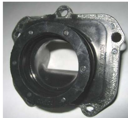
Podem existir alguns defeitos de fábrica na junção do contorno interno e na face de montagem do carburador. É uma operação manual que se faz para retirar uma pequena esquina de menos de 3 mm em espessura. Não é permitido limar ou polir.
