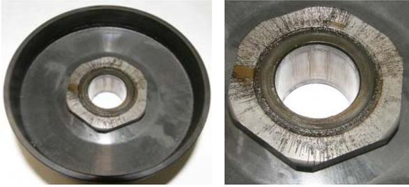
**6.13.6.** No caso em que é usado o pinhão de 11 dentes, toda a área da campânula deve estar completamente limpa de qualquer substância lubrificante (massa, gordura ou outro líquido).
