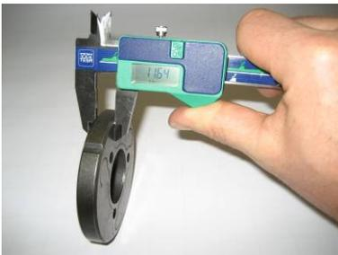
**7.14.4.2. Espessura da sapata da embraiagem** (conforme imagem abaixo). O valor da medida não pode ser inferior a **24,10 mm**.
