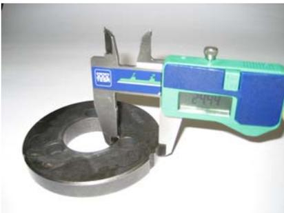
**7.14.4.3. Diâmetro exterior da campânula.** O diâmetro exterior da campânula deve ser medido conforme indica a figura abaixo. A medição deve ser feita pelas costas da campânula e não pela parte da abertura da mesma (conforme imagem). O valor mínimo do diâmetro exterior é de **89,50 mm**.
