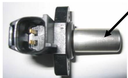
Para verificar a legalidade do pick-up coloque uma esfera de metal (3-5mm de diâmetro) na parte plana do pick-up (do lado do motor) e a esfera deve manter-se no centro. Caso contrário o pick-up não está legal.
