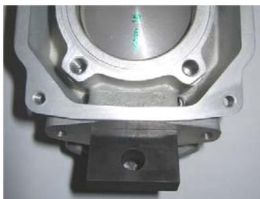
Tal como é fornecida pelo fabricante sem que se permita qualquer modificação. Se mover o pistão até acima e cobrir completamente a saída de escape, é possível introduzir a peça ROTAX (277 030) até que esta pare na superfície do cilindro
