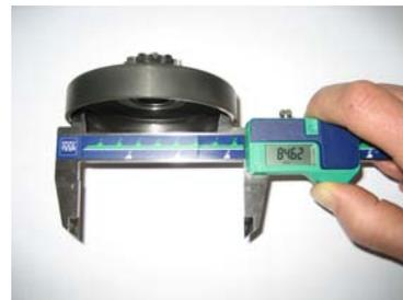
**6.13.8.4. Altura da campânula com o pinhão montado.** A altura mínima é de **33,90 mm**
