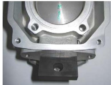
**7.6.4.** O comprimento da válvula de escape é de 36,5mm (+0,2 /-0,3mm). A largura do topo é 4,8 mm (+ 0,3/-0,3 mm).
