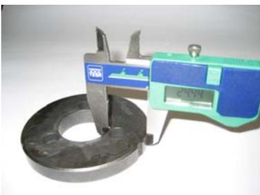
**6.13.8.3. Diâmetro exterior da campânula.** O diâmetro exterior da campânula deve ser medido conforme indica a figura abaixo. A medição deve ser feita pelas costas da campânula e não pela parte da abertura da mesma (conforme imagem). O diâmetro mínimo é de **89,50 mm**.
