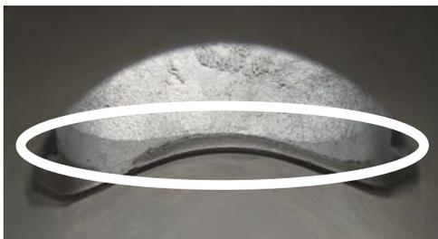
**7.5.10.** A distância entre o topo do cilindro e o topo da janela de escape deve ser comprovada com a peça ROTAX 277 397.
