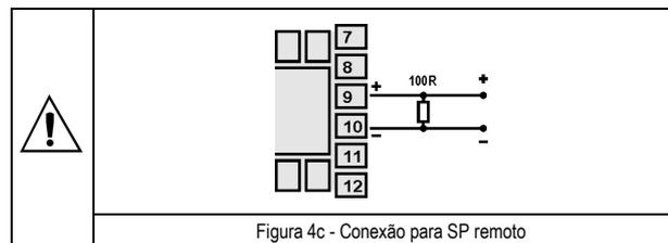
Figura 4c - Conexão para SP remoto
