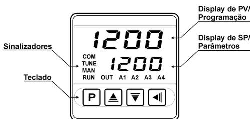
Figura 7 - Identificação das partes do painel frontal
