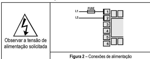
Figura 2 – Conexões de alimentação
