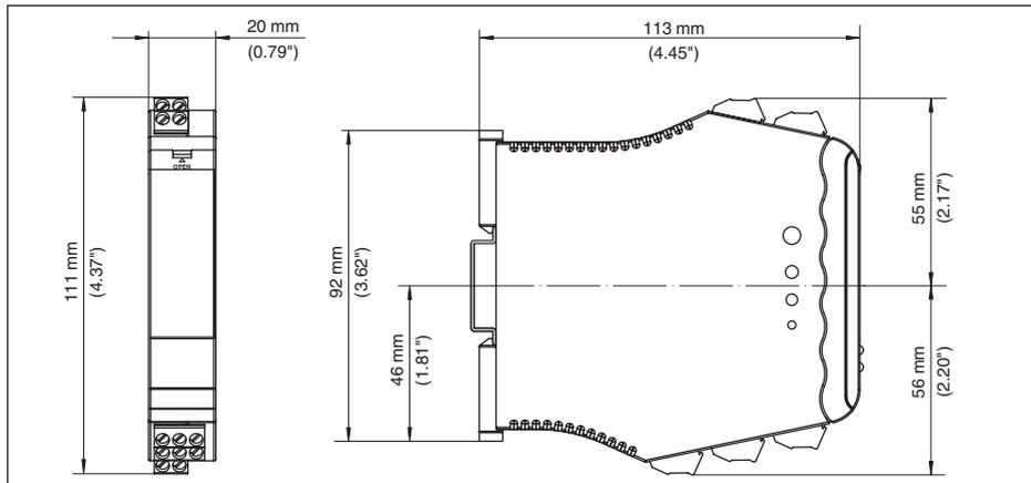
Fig. 54: Dimensões VEGATOR 112
