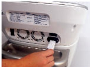
2) Conecte o cabo de força ao seu aparelho.
