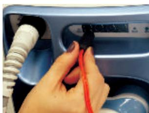
6) Conecte o cabo para os eletrodos.
