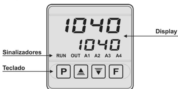
Fig. 02 - Identificação das partes do painel frontal
