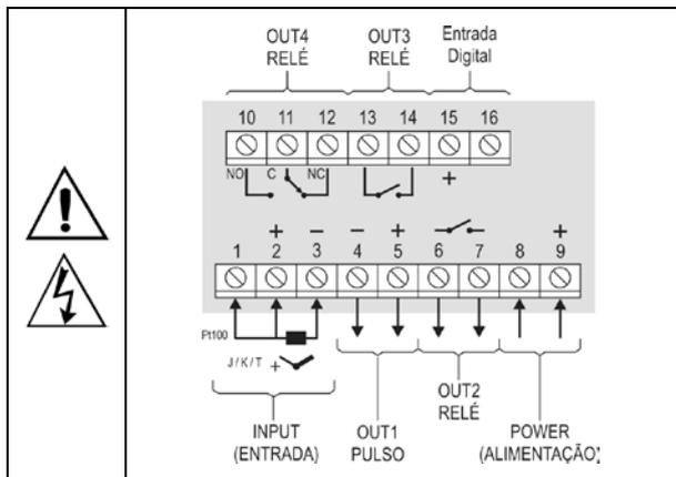
Fig. 01 - Conexões das entradas, saídas e alimentação
