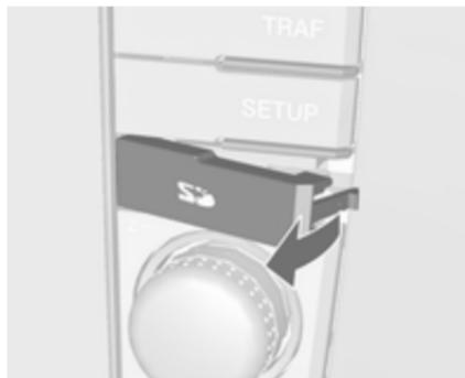
A tampa pode ser retirada, p. ex., utilizando um clipe de papel ou objecto semelhante.
