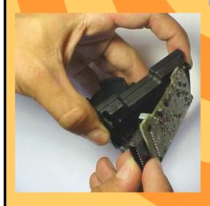
Retirando a placa de circuito do imobilizador GM 1
