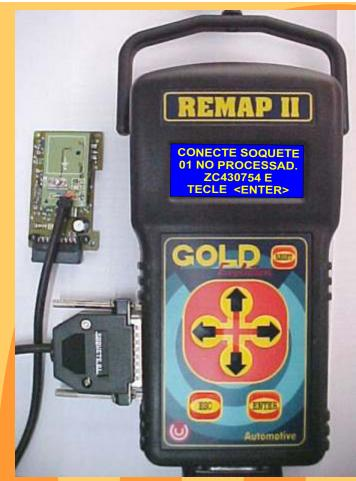
Soquete 01 conectado ao Microprocessador
