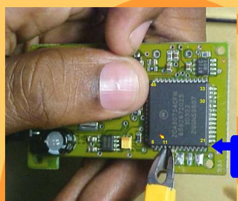
Cortando o pino 11 do Microprocessador (usar alicate pequeno tipo usado para tirar cutícula)
