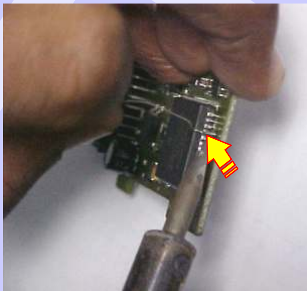
Soldando novamente o pino 30 no Microprocessador
