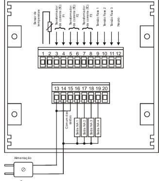
OBS.: NÃO ATERRAR AS ENTRADAS DOS TRANSFORMADORES DE CORRENTE. POIS ESTAS NÃO SÃO ISOLADAS DO CIRCUITO ELETRÔNICO PODENDO DANIFICAR O EOUIPAMENTO.
