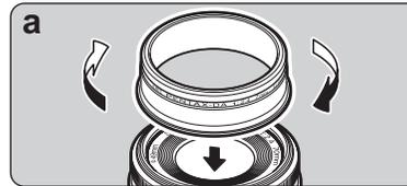
**a. De enroscar (pára-sol específico para a DA 70 mm f/2.4 Limitada)**
