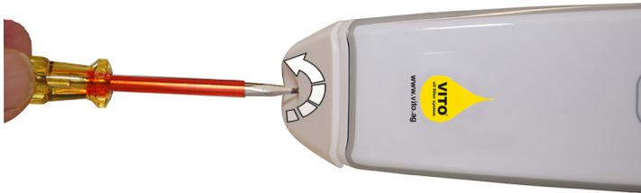
1. Desenroskar o parafuso no compartimento das pilhas.
