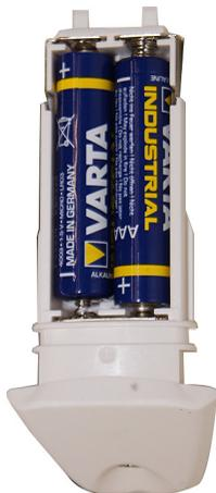
3. Colocar as pilhas. Ter atenção à polarização correcta.
