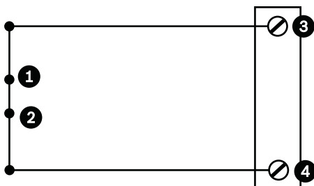
Figura 9.3 NF Ligações normalmente fechadas
