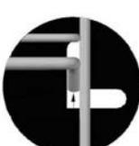
3. Levantar na vertical e retirar o perno colocado na ranhura da frente no lateral do forno
