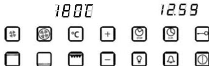
Durante estes 4 segundos, o utilizador deve começar a definir a temperatura usando as funções ou . A temperatura pode ser ajustada dentro de um intervalo de 30°C a 250°C, com incrementos de 5°C.
