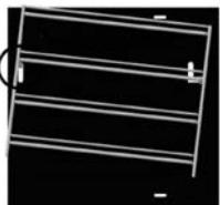
1. Levante la parrilla na vertical y retirar la inserción en la ranura en la parte diantera del horno
