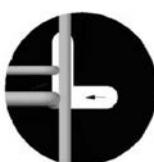
2. Deslocar a grelha no sentido indicado de forma a que se desloque na ranhura junto à costa do forno
