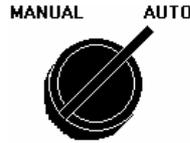
Para operação em Automático, rode o selector "Manual / Automático" para a Direita
