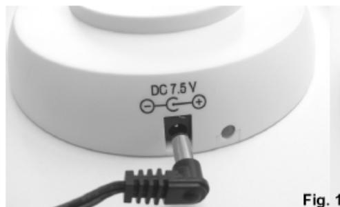
**WAARSCHUWING!** Trek de plug uit en plaats het stopje op de connector na het opladen. Laat geen water binnen de connector dringen.
