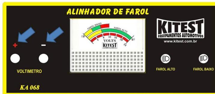
21. Com as pontas perfurantes conecte nos terminais correspondentes a lâmpada do farol a ser testado e faça a leitura do voltímetro, caso as tensões
