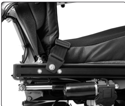
Orifício para fixação do cinto.
