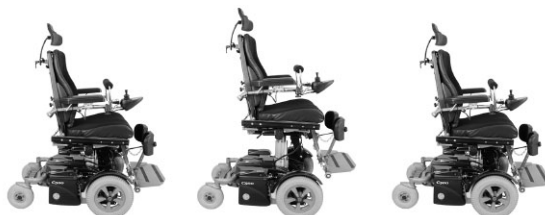
Movimentos da cadeira com ajuste da altura.
