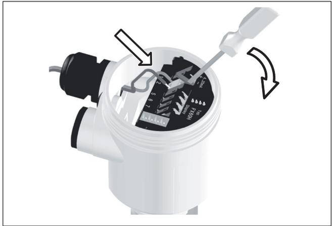
Fig. 7: Passos 6 e 7 do procedimento de conexão
