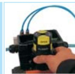
Após o ajuste dos acionadores, feche a caixa do monitor apertando firme todos os parafusos que fixam a tampa a caixa afim de evitar penetração de líquidos.
