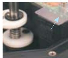
Para indicar, por exemplo válvula fechada, ajuste o came inferior para que permaneça sob o sensor 2, para tanto suspenda o came e gire-o até encontrar o alvo 2, observe o acionamento via led da entrada 2.
