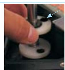
Após o ajuste dos cames, feche a caixa do monitor apertando firme todos os parafusos que fixam a tampa a caixa afim de evitar penetração de líquidos.
