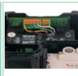
Puxe os cabos de rede deixando o mínimo necessário dentro da caixa, coloque e aperte os parafusos que fixam o módulo e o derivador na caixa do monitor.
