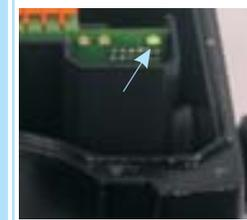
Para indicar, por exemplo válvula fechada, ajuste o acionador inferior para que permaneça sob o sensor 2, para tanto e gire-o até encontrar o alvo 2, observe o acionamento via led da entrada 2.
