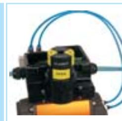
Ajuste o acionador superior para que permaneça sob o sensor 1, o ajuste deve ser realizado girando-o até a posição de acionamento 1, e observe o led de acionamento da entrada 1.
