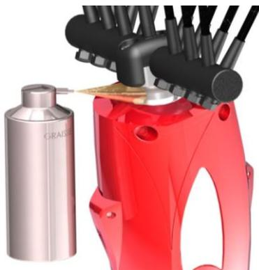
Posicionar a ponteira do aerosol na direcção da rótula. Manter o aerosol na vertical e depois premir. LUBRIFICAR a cabeça de vibração no mínimo uma vez por dia (esta lubrificação efectua-se sem desmontar nada).
