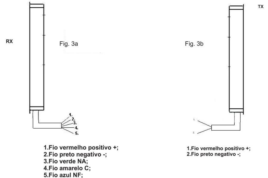
**Obs: Sempre instale as barreiras com o fio virado para baixo evitando assim a entrada de água.**
