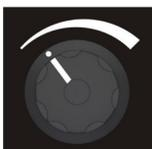
O botão de controlo da amperagem principal pretende constituir um método rápido de selecção para ajustar a configuração da amperagem principal. Esta função permite aos utilizadores saírem rapidamente da secção do sequenciador da U/I, eliminando a necessidade de percorrer todas as possíveis funções do sequenciador para ajustar a amperagem principal ou sair do menu do sequenciador.
