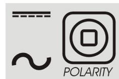
Este ícone serve para configurar a polaridade do processo utilizado: operações CC+, stick CA, CC- e TIG CA.
