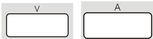
O visor direito apresenta a corrente de soldadura predefinida (A) antes da soldadura e a corrente de soldadura real durante a soldadura, e o visor esquerdo mostra a tensão (V) nos cabos de saída.
