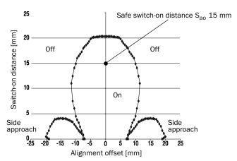
Quando o atuador se move lateralmente à superfície do sensor, devem ser mantida uma distância mínima de 4 mm. Isso impede um disparo precoce causado pelas áreas de encosto laterais.
