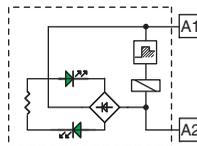
Ilustração 7.2: Circuito do eletroímã através dos bornes A1 e A2
