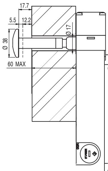
Ilustração 3.6: Dimensões do L200 com AC-PB60-L200 em mm
