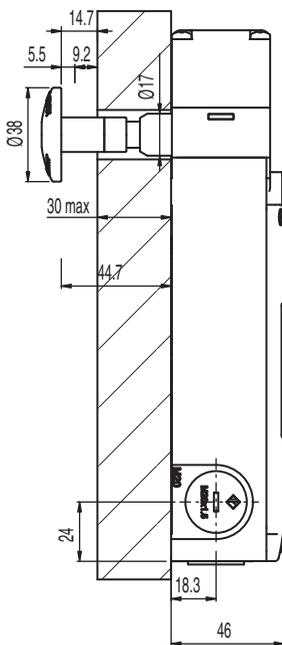
Ilustração 3.4: Dimensões do L200 com AC-PB30-L200 em mm
