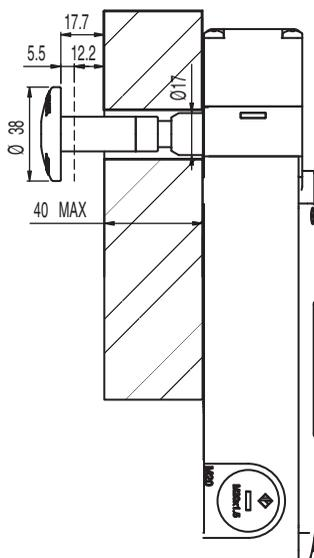
Ilustração 3.5: Dimensões do L200 com AC-PB40-L200 em mm
