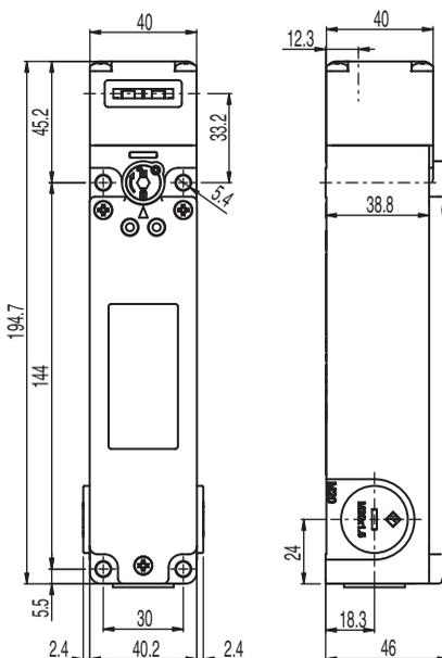
Ilustração 3.1: Dimensões do L200-M1C3-SLM24-L2G em mm
