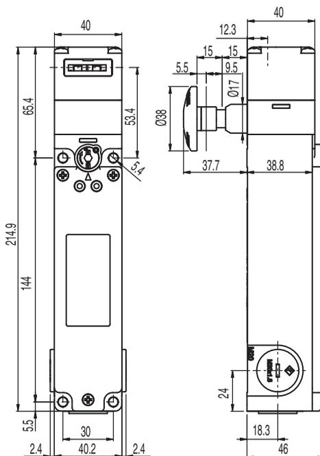
Ilustração 3.3: Dimensões do L200-M1C3-SLM24-PB-L2G em mm
