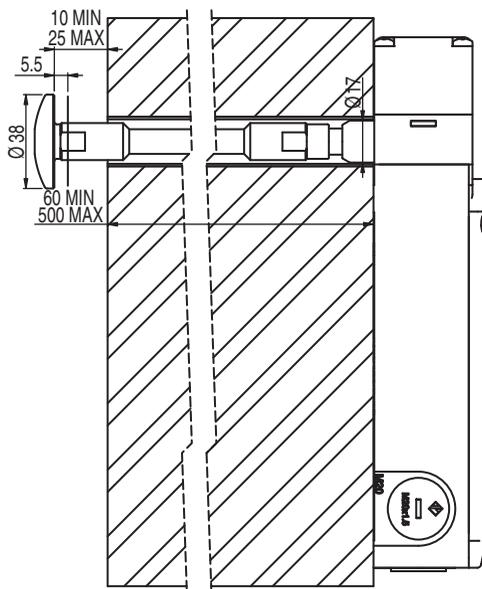
Ilustração 3.7: Dimensões do L200 com AC-PB500-L200 em mm
