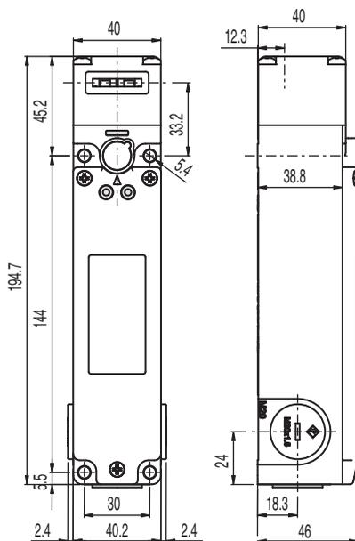
Ilustração 3.2: Dimensões do L200-M1C3-MLM24-L2G em mm
