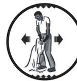
Ferramentas pneumáticas podem apresentar vibração quando em uso. Vibração, movimentos repetitivos ou posições desconfortáveis podem ser prejudiciais às suas mãos e braços. Pare de usar qualquer ferramenta se surgir desconforto, sensação de formigamento ou dor. Procure orientação médica antes de voltar a trabalhar.
