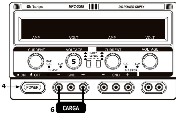
Figura 6 - Conexão das Fontes MPC-3003 e MPC-3005.
