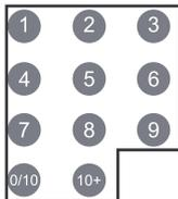
As teclas de dígitos podem ser usadas para inserir números ou selecionar uma faixa. Por exemplo, pressione [2] para selecionar a faixa 2; pressione [10+] duas vezes, depois pressione [1] para selecionar a faixa 21.
