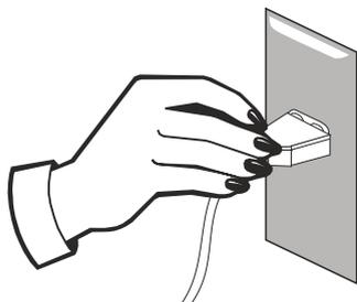
Não use o aparelho abaixo de 90V ou acima 220V. Quando a voltagem está abaixo de 90V, a máquina pode não trabalhar e sua vida útil será afetado. Quando a voltagem estiver acima 220V, o aparelho pode ser queimado completamente ou causar incêndio.
