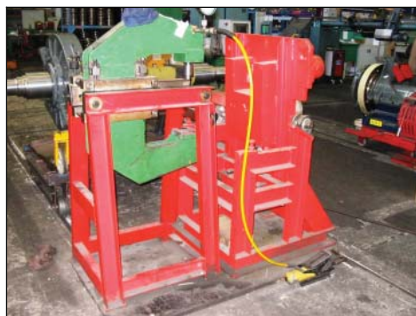
PA133 acionando uma prensa para curvatura na Fabricação
