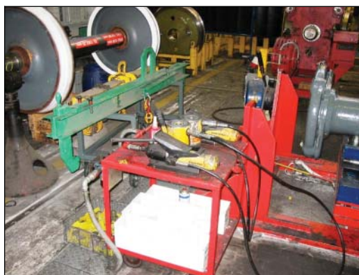
Bombas PA133 acionando cilindro vazado em aplicação de prensagem
