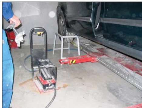
Bomba Turbo pneumática, acionando um elevador para carros (CRO)
