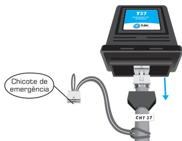
2) Conectar o chicote de emergência no chicote variador, reestabelecendo a conexão original do sensor de rotação do veículo.
