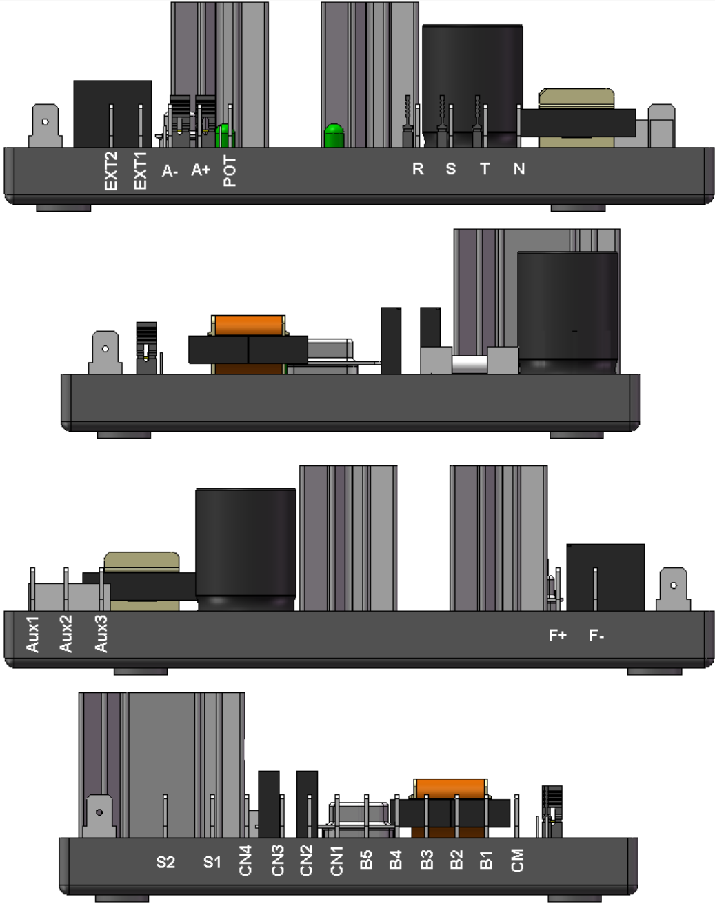
Figura 6.1.1: Terminais de conexão do regulador A tabela 6.1.1 apresenta a listagem dos terminais e sua função.
